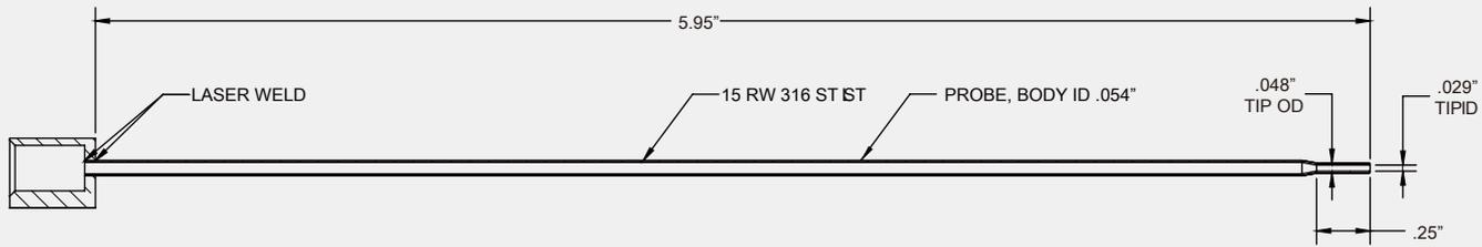
带有DP3抛光和针尖变径的标准探针DB200-14953
